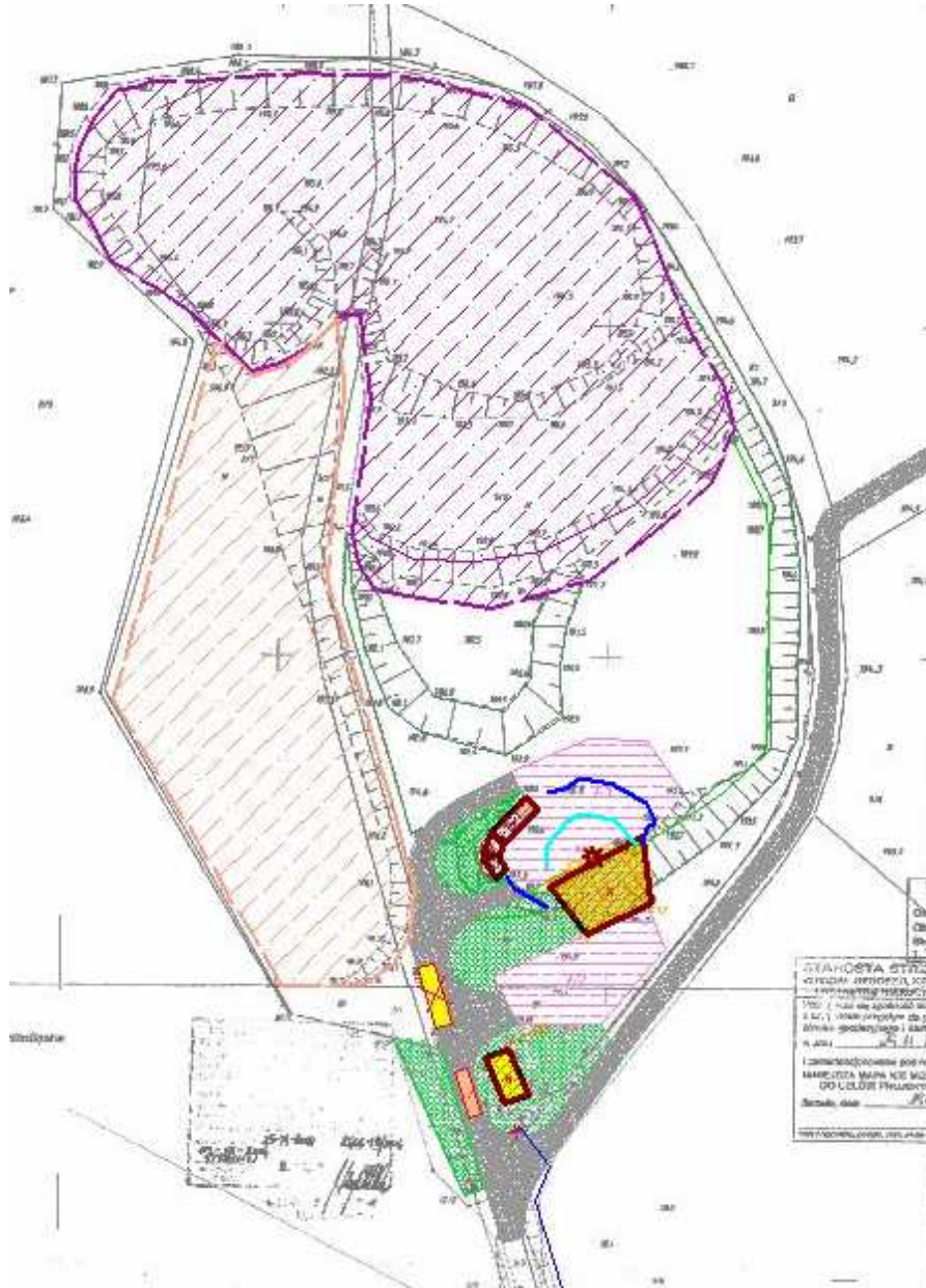
Rysunek 1.1. Budowa projektowanej stacji przeładunkowej odpadów w Wąwolnicy – zasięg oddziaływania hałasu o poziomie 55 dB w porze dnia, wysokość punktu obserwacji h = 4 m
